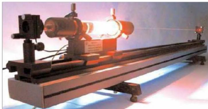
Figura 1: Imagen del láser de gas helio-neón en funcionamiento
