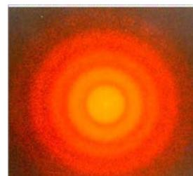
Fig. 4 Difracción de un glóbulo rojo con un láser de He-Ne
