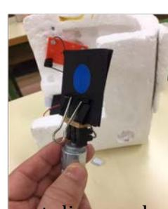
El motor necesita una pila pequeña de 1,5 Voltios. En la pinza se coloca una cartulina con los colores que se quieren mezclar: uno a cada lado.
